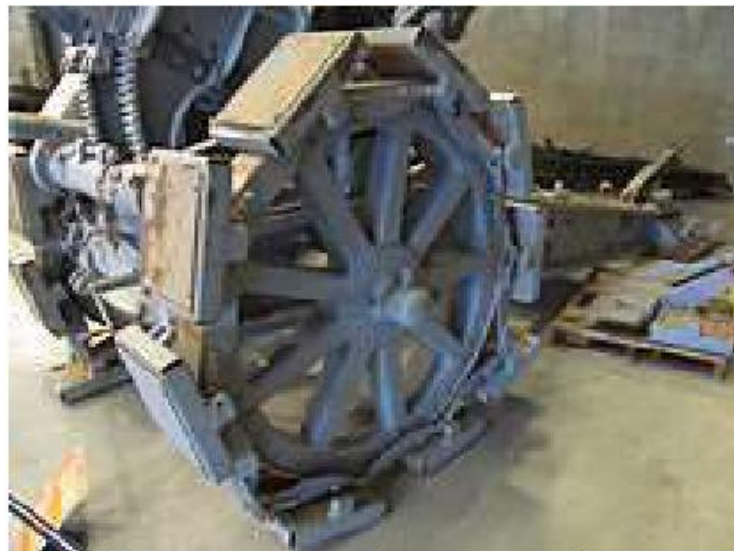
Particolare della ruota con cingolo Bonagente installato.
